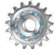
¿En qué sentido girarán acoplados los anillos exterior e interior? ¿En qué sentido de giro del anillo exterior, el anillo interior se independiza y no gira con él?
