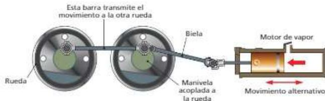
El mecanismo que produce el movimiento es el mismo en la bicicleta y en el tren: en la bicicleta nuestra pierna es la biela que se desplaza induciendo el giro de la manivela, que serían los pedales, mientras que, en el tren, el movimiento lo produce el pistón de la caldera de vapor, que se desplaza horizontalmente. El movimiento de la biela es de vaivén en un extremo (desplazamiento lineal alternativo) y circular, como el de la manivela, en el otro.
