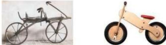
La rueda es el mecanismo básico de la bicicleta. Con ella se facilita el desplazamiento al reducirse la superficie de contacto con el suelo y disminuir el rozamiento. A su vez, el rozamiento es necesario para que la rueda avance, pues es el agarre al suelo el que la obliga a ello.
