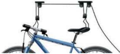
En el dibujo observamos que al tirar de la cuerda la bicicleta se eleva, y que la cuerda pasa por distintas poleas en un recorrido en el que sube y baja cuatro veces, lo que significa que la bicicleta se elevará una distancia cuatro veces menor que el trozo de cuerda que deslicemos; por ejemplo, si recogemos un metro de cuerda la bicicleta subirá solo 25 cm.
