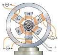
Interior de un alternador.
